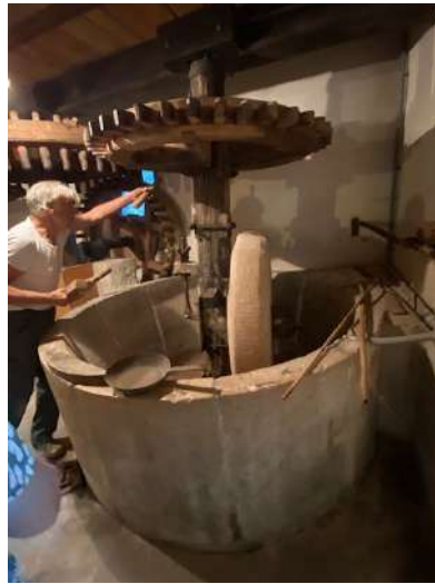
Explication du fonctionnement des pistes d'écrasement des olives
